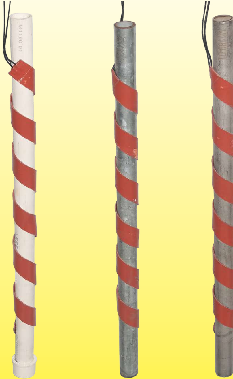
对比性测试的条件：硅胶加热带缠绕在外径 25mm 的管上，管的材质为 PVC-U、镀锌钢和不锈钢
