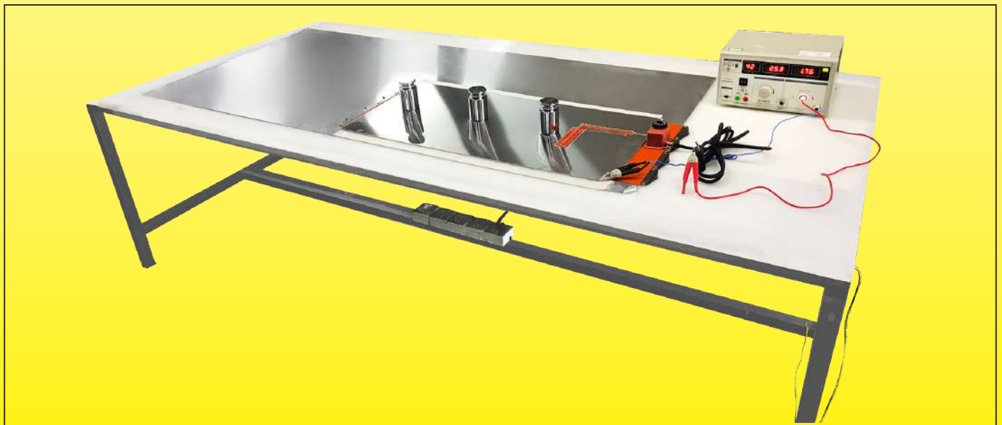
在冷态的条件下总泄漏电流的测量设备
